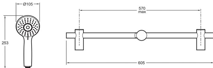
Спецификация продукта : Комплект для душа (стойка, шланг, ручной душ). E29848. Коллекция : OSCAR. МАТЕРИАЛ : Металл. ТИП УСТАНОВКИ : Крепление к стене. ТИП ШЛАНГА : Гладкий с защитой от скручивания. КОЛИЧЕСТВО ВЫПУСКНЫХ ОТВЕРСТИЙ : 3.
